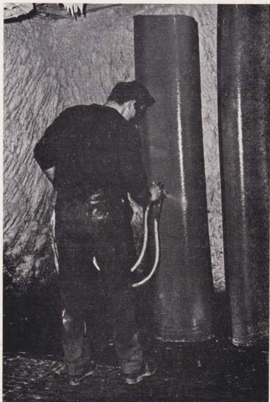
Glazuur wordt op de retort gespoten
