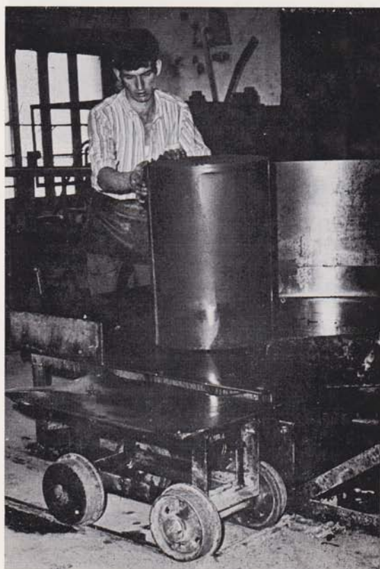
Via een lift wordt de streng naar de retortenpers gebracht
